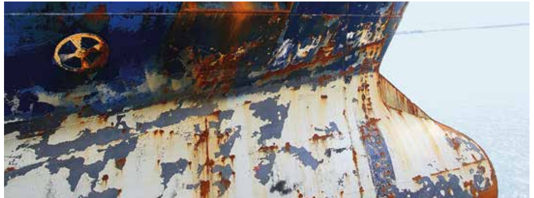
Reif für den Pinsel: Der harte Einsatz hinterlässt Spuren. Ein neuer Schutzanstrich birgt Einsparpotenzial
