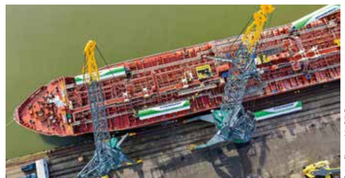
Aufbauarbeit: In Rotterdam wurden die vier VentoFoil-Rotoren auf dem Produktentanker „Chemical Challenger“ installiert
