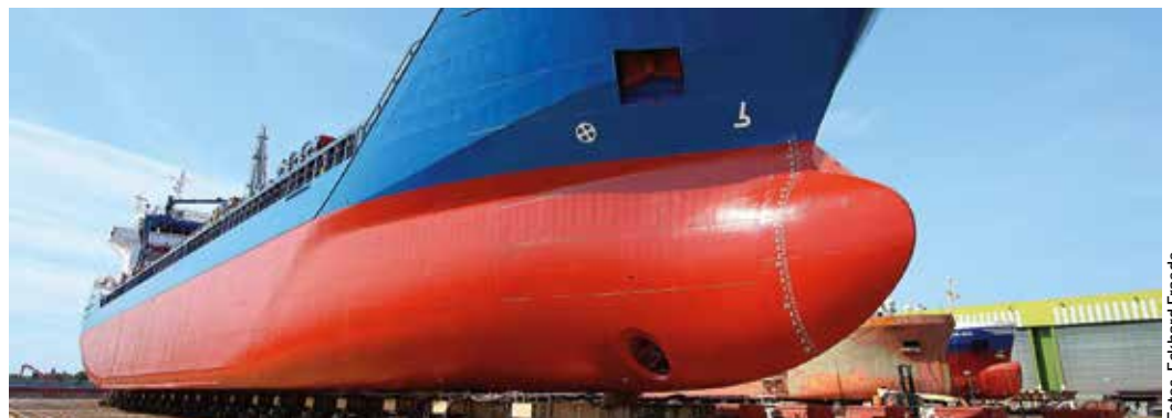
Nicht fürs Auge: Ein neuer Schutzanstrich trägt auch zur Reduzierung des Reibungswiderstandes bei
